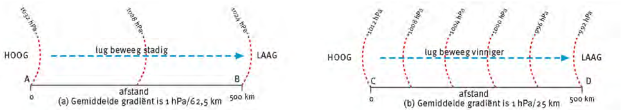
FIGUUR 33 (a) 'n Sagte of gelykmatige drukgradiënt lei tot stadige windspoed. (b) 'n Steil drukgradiënt lei tot hoër windspoed.
